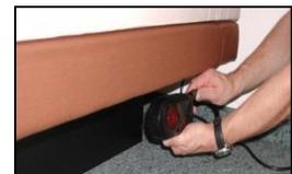
13. Erste Einstellung am Regler ist 28°C. Evtl. Kindersicherung drücken. Das Kontrolllicht wird ausgehen, wenn der eingestellte Wert erreicht ist. Eine Temperatur-Veränderung (aufwärmen/abkühlen) kann bis zu einem Tag dauern.
