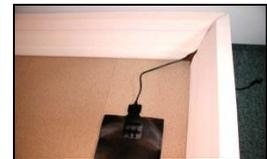
10. Wärmemattenkabel nicht unter dem Schaumrahmen einklemmen und nicht auf die Wärmematte legen. Das Kabel wird in der Ecke des Kopfes, im Spalt aus dem Schaumrahmen geführt.
